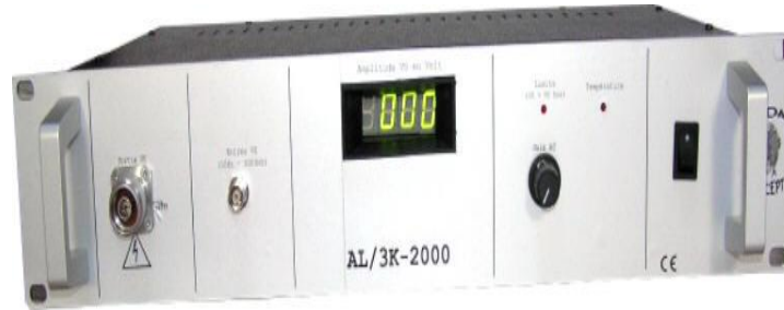
Fig I .12. Alimentation haute tension : AL/AC-3K-2000
