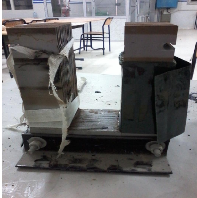
Fig. III. 2. Préparation du circuit magnétique en forme de U
