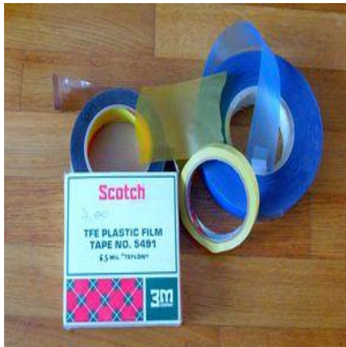
Fig. III. 7. Quelques isolants utilisés entre les couches de spires
