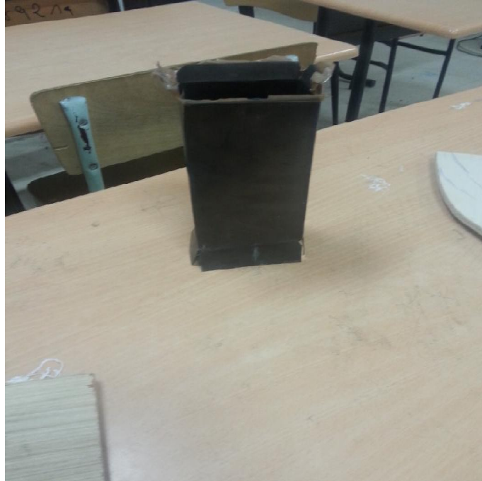
Fig. III. 8. Isolant à film plastique utilisé entre le bobinage et circuit magnétique
