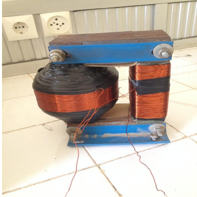
Fig. III. 9. Alimentation 2 kV réalisée
