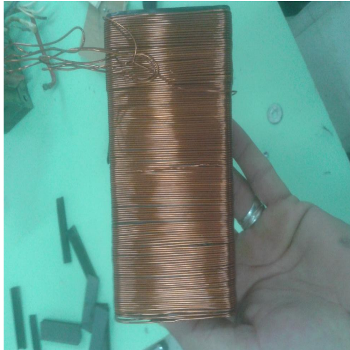
Fig. III.5. Bobinage primaire 315 spire avec un fil en Cuivre de 0.8 mm
