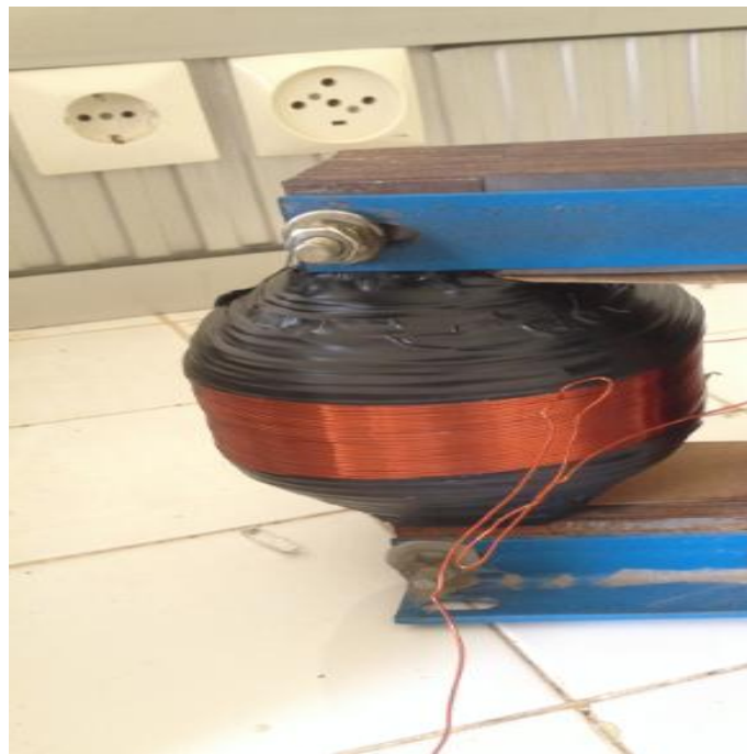
Fig III. 6. Bobinage secondaire en Cuivre
