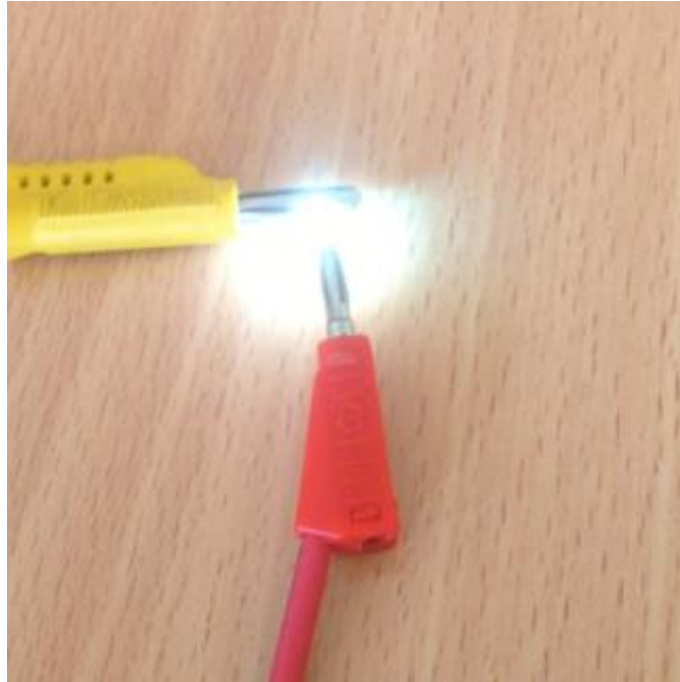
Fig.III.12 Décharge couronne entre deux pointes
