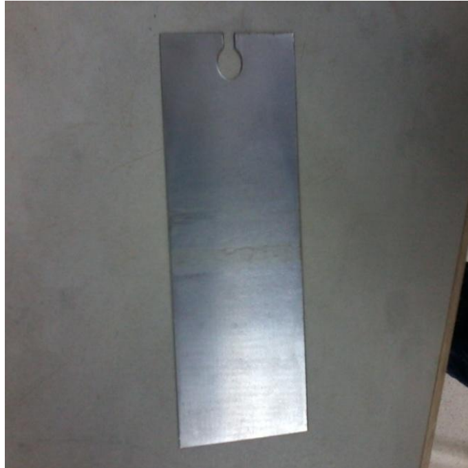
Fig. III.3. Tôle utilisée pour la construction du circuit magnétique
