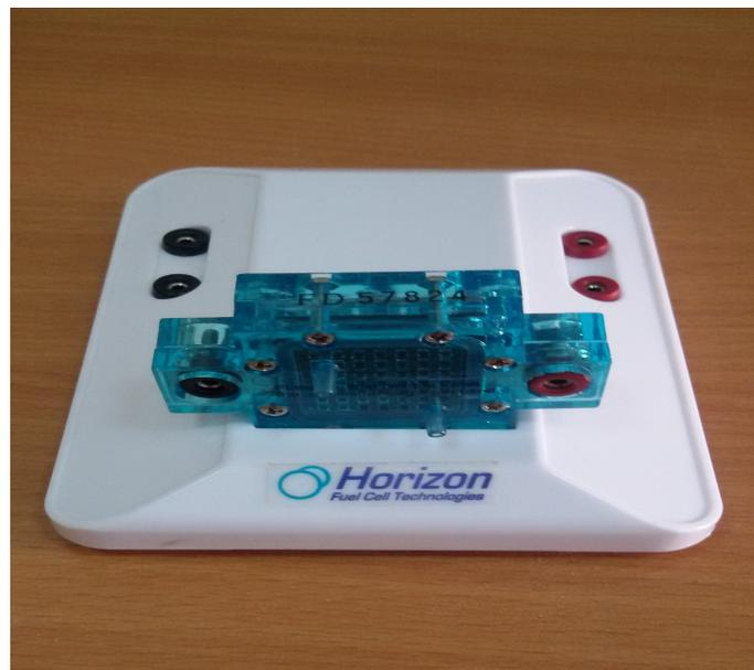
FIGURE 2.4 – Pile à combustible de type PEM.
