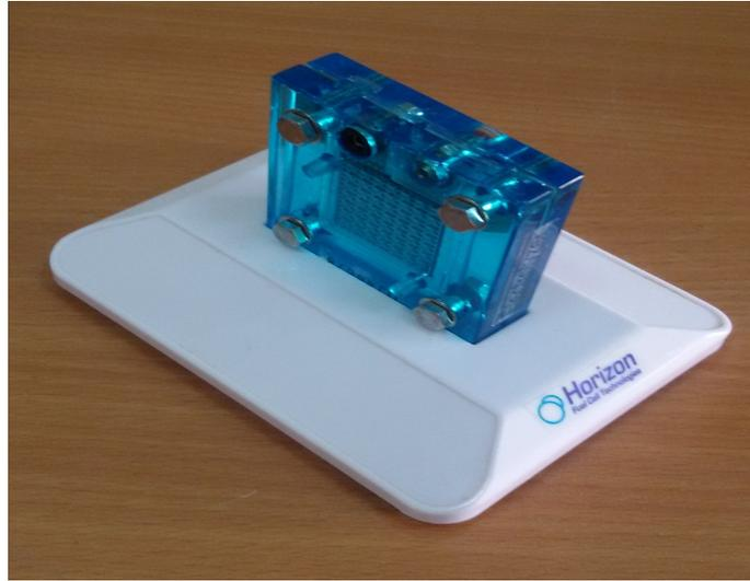
FIGURE 2.2 – L'électrolyseur de type PEM.
