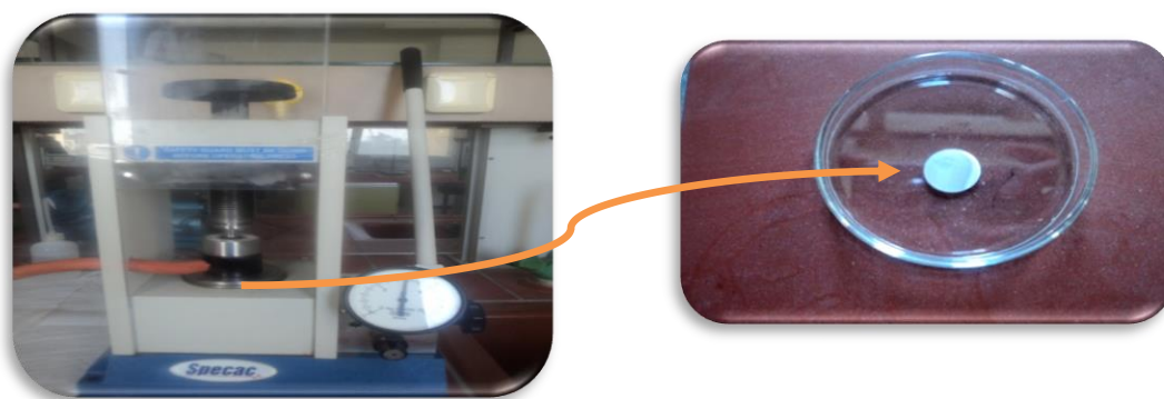
Figure II. 15 : Préparation des pastilles en KBr par la presse.
