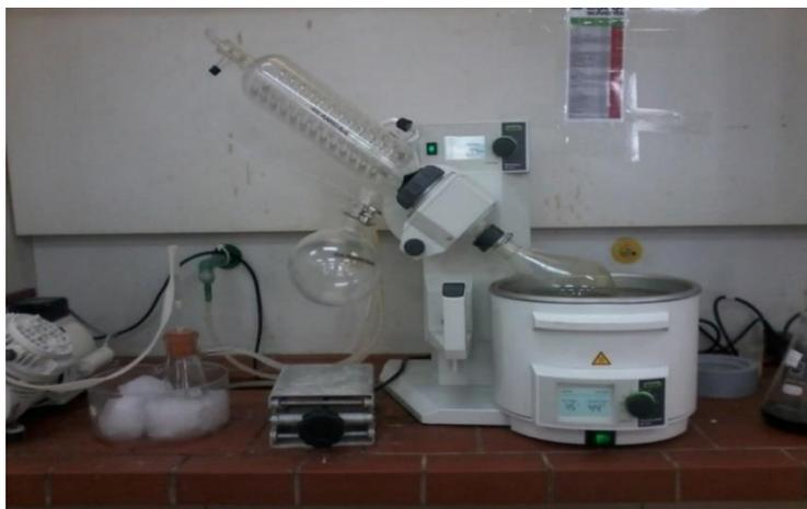
**FIGURE III.5** : Evaporateur rotatif
