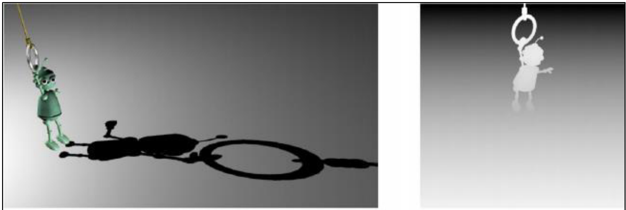
Figure 14 : Shadow mapping. À gauche, vue de la caméra. À droite, tampon de profondeur vu de la lumière, encodé en niveaux de gris. [10]
