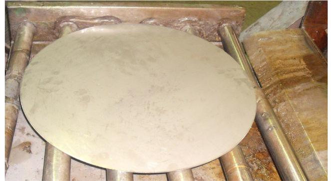
Figure 2 : Tôle circulaire prédisposée à l'emboutissage
