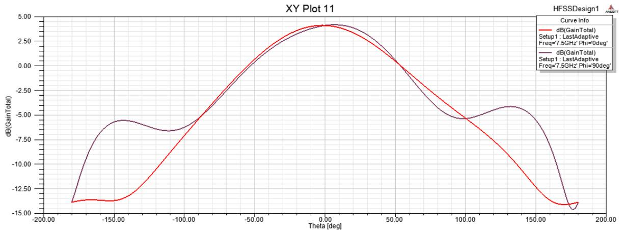
Figure(III.30) : le gain de deux antennes patch rectangulaires couplées magnétiquement
