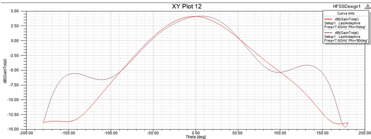
Figure(III37.) :le gain d'antenne
