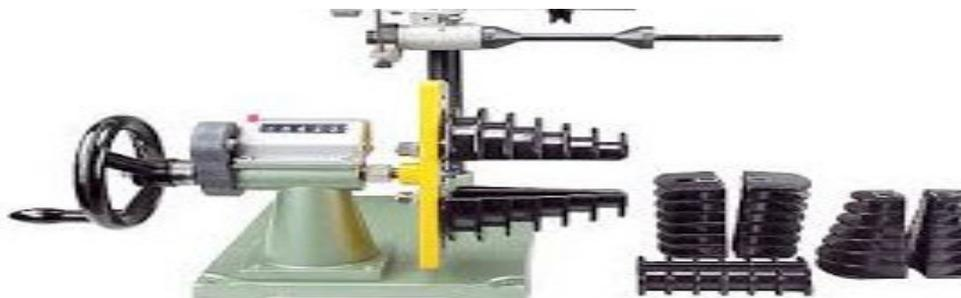
Figure III.4 Préparation des bobines
