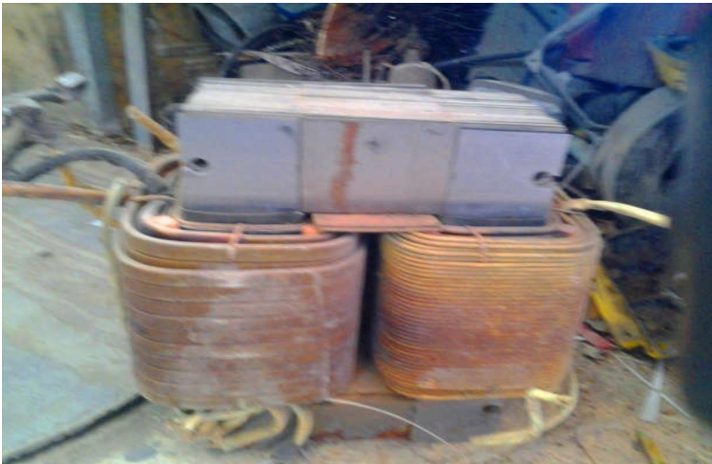
Figure III.1. Transformateur de poste à soude.
