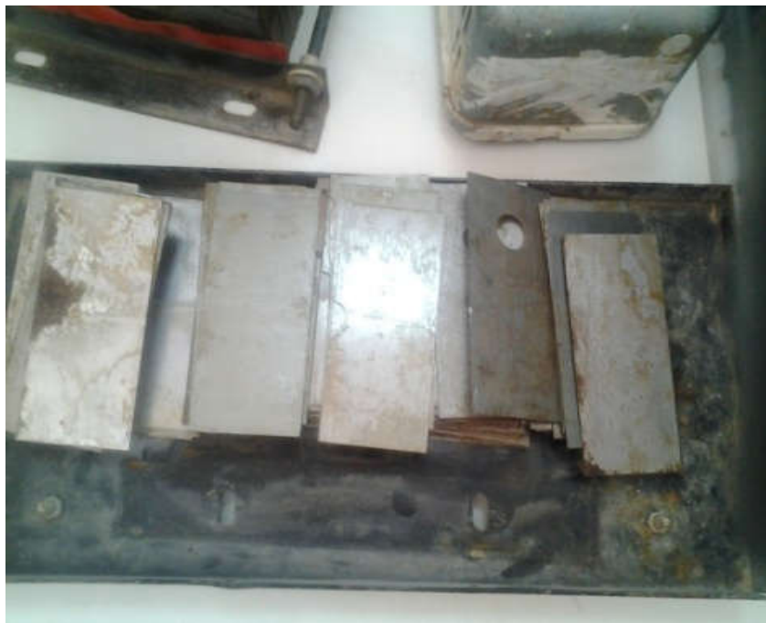
Figure.III.6. Tôles magnétiques utilisées dans la fabrication du circuit magnétique.
