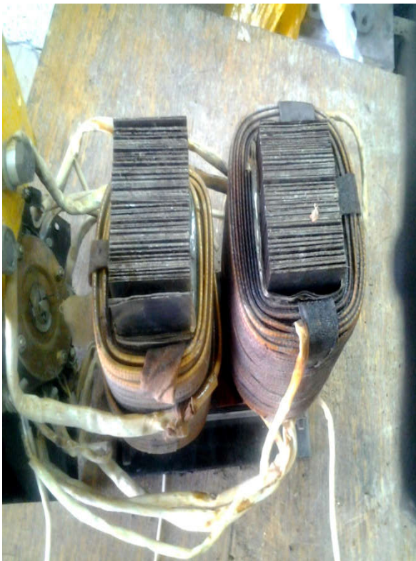
Figure. III.3.4. Démantèlement de bobinage primaire et secondaire.
