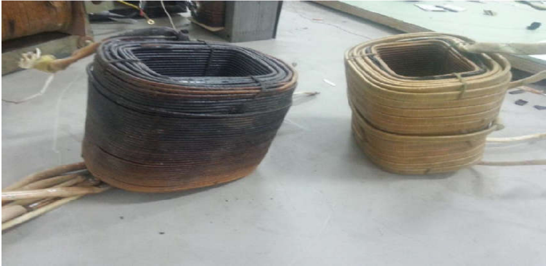
Figure.III.2. Bobinage primaire endommagé (gauche) et bobinage secondaire saint (droit).
