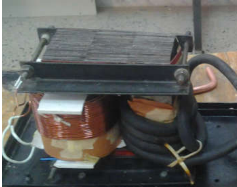
Fig.III.17. Resserrage des tôles.
