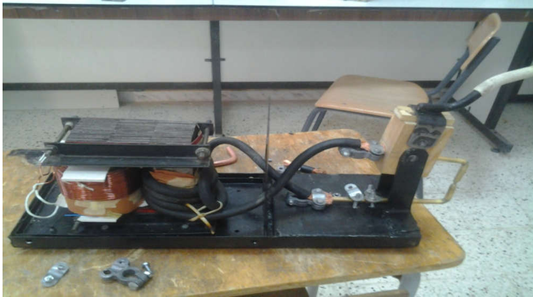
Fig.III.19. Bobinage secondaire lié avec les bars du cuivre.
