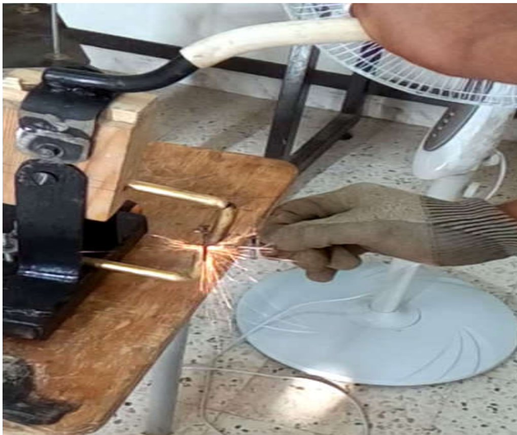
Figure III.23. Premier étape de soudage.
