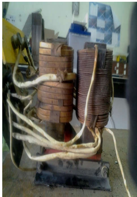
Figure. III.3.4. Démantèlement de bobinage primaire et secondaire.
