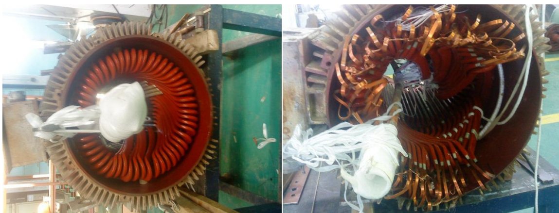
Fig(IV-7) Montage de bobinage.
