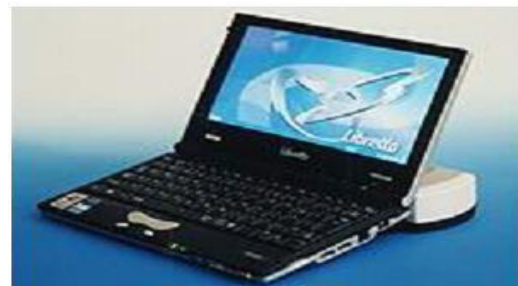
Figure I.5 : Pile à combustible au méthanol Toshiba (2004) , autonomie = 20h, poids = 900g
