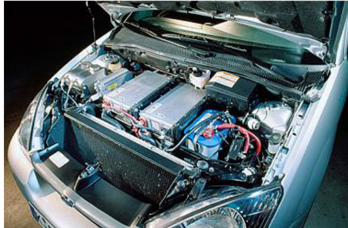
Figure I.4 : Pile Ballard Mark 90 embarqué dans le véhicule Ford FCV (85kW) [Gui04]
