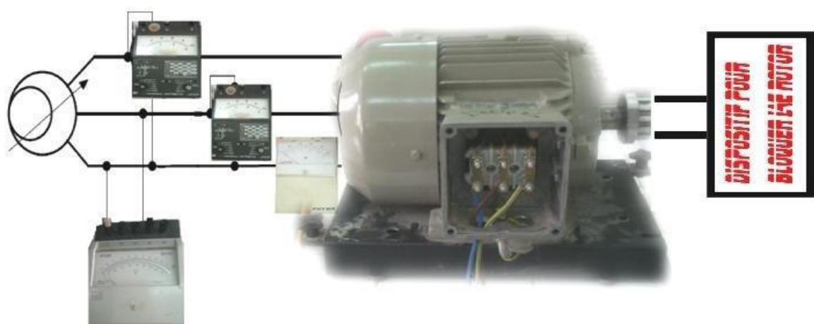
Fig. III.4: Schéma de principe de l'essai en court-circuit
