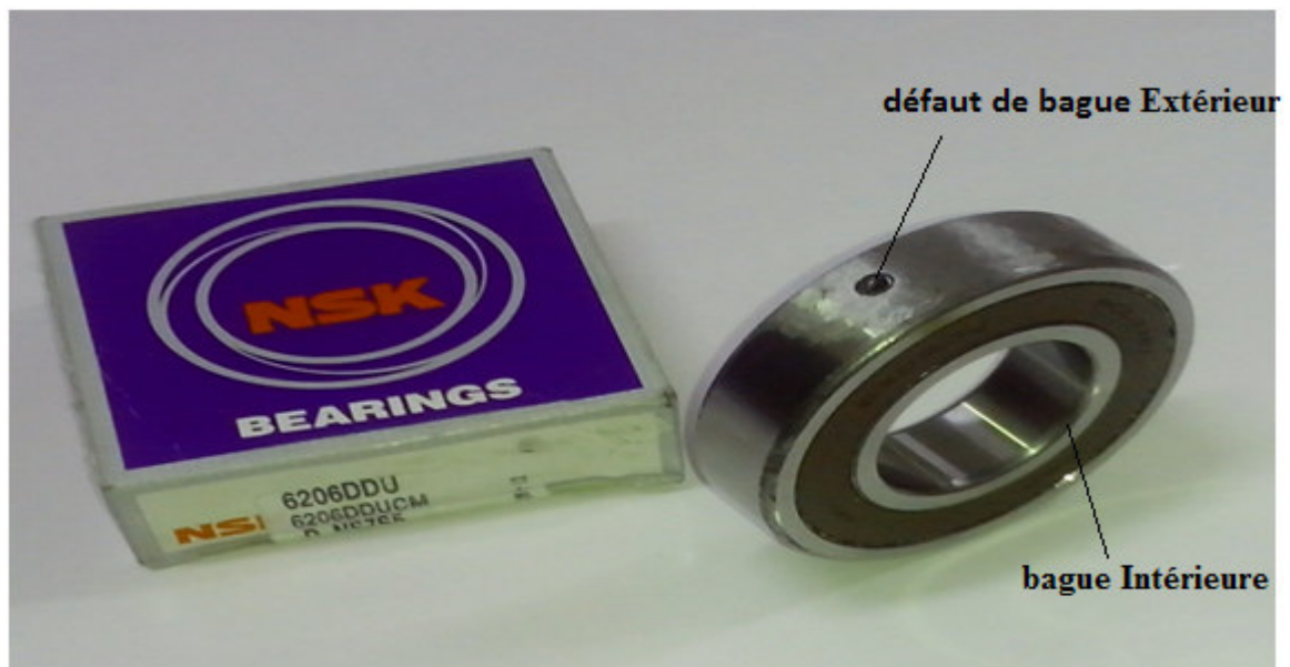
Figure. III.2. Roulement avec défaut de la bague extérieure.
