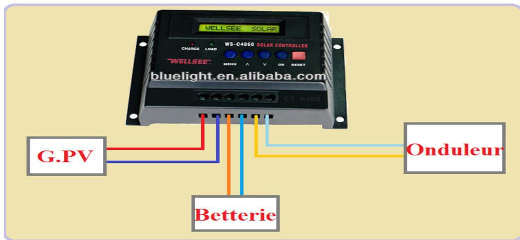
Fig. (III -19) : La connexion de régulateur avec les autres éléments
