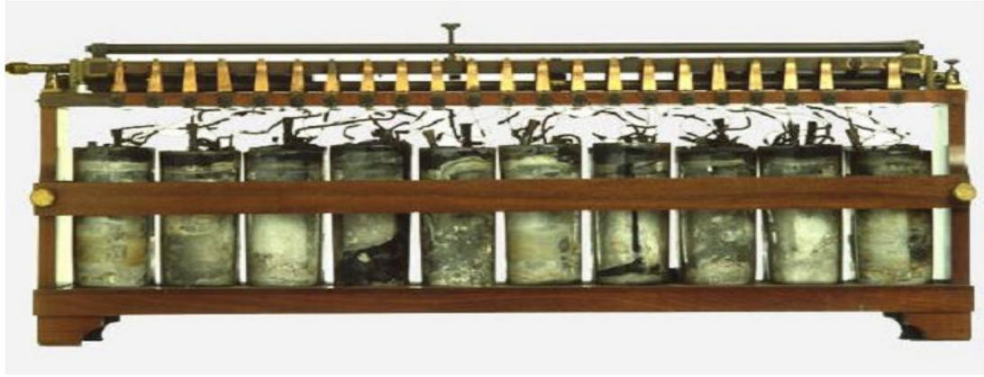
Fig. (I -17): Première batterie d'accumulateurs conçue par Gaston Planté. [22]
