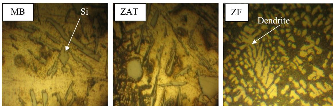
**Figure V.2.** Microstructure des zones (MB, ZAT, ZF) du joint soudé de l'AlSi12 traité à 100°C pendant 30 minutes (x400).
