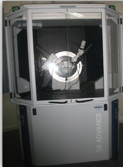
**Figure IV.3.** Diffractomètre de type D8 Advance.
