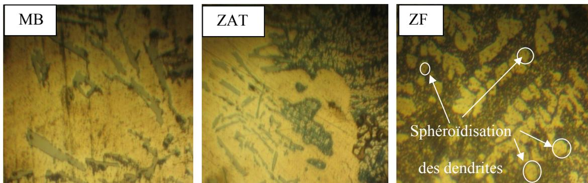
**Figure V.4.** Microstructure des zones (MB, ZAT, ZF) du joint soudé de l'AlSi12 traité à 300°C pendant 30minutes (x400).
