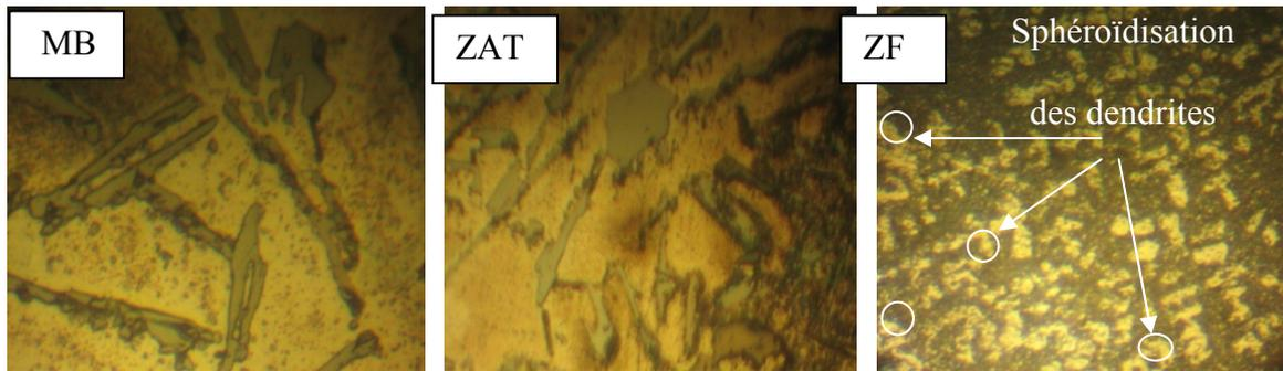
**Figure V.3.** Microstructure des zones (MB, ZAT, ZF) du joint soudé de l'AlSi12 traité à 200°C pendant 30minutes (x400).
