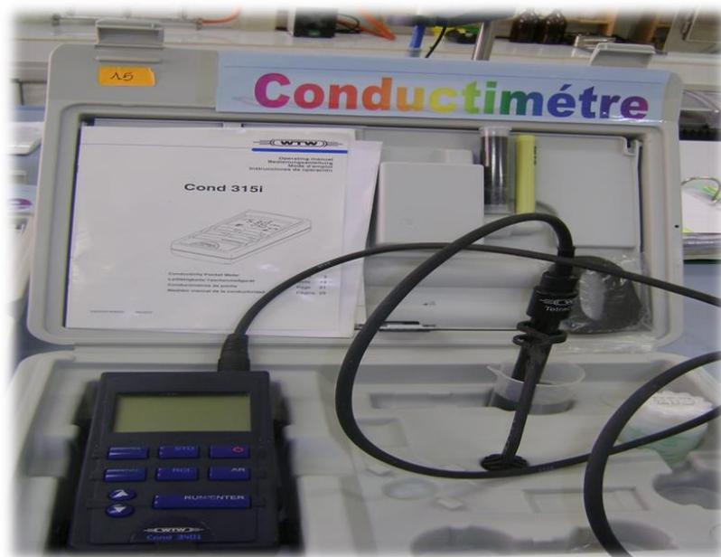
Figure 19 : Conductimètre
