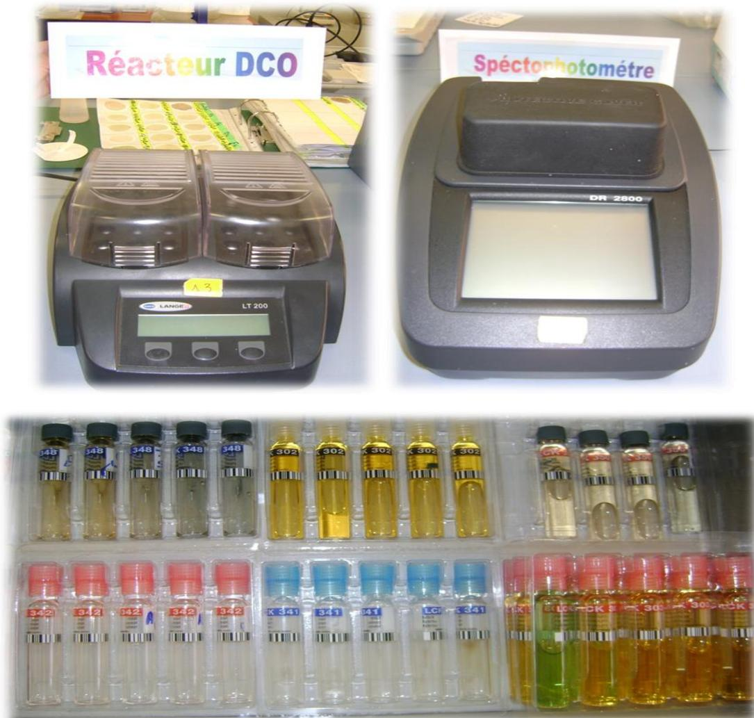
Figure 22 : Réactifs DCO et appareils de mesure.
