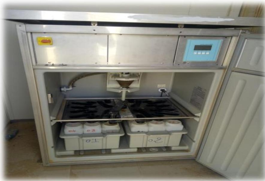
**Figure 17:** Echantillonneur automatique
