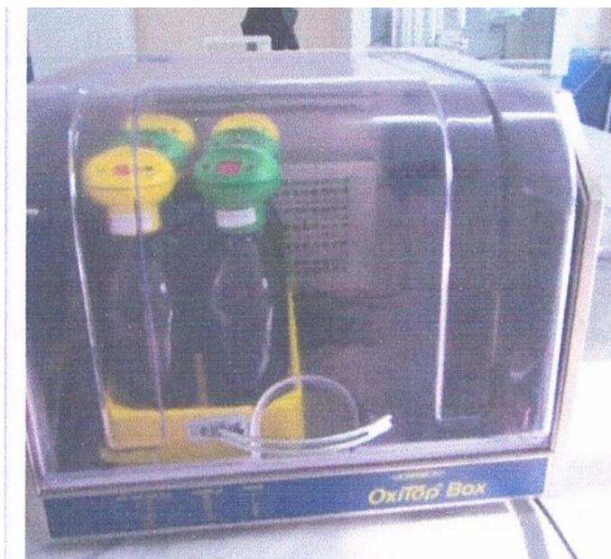
**Figure 15:** Appareils de mesure de la DBO<sub>5</sub>
