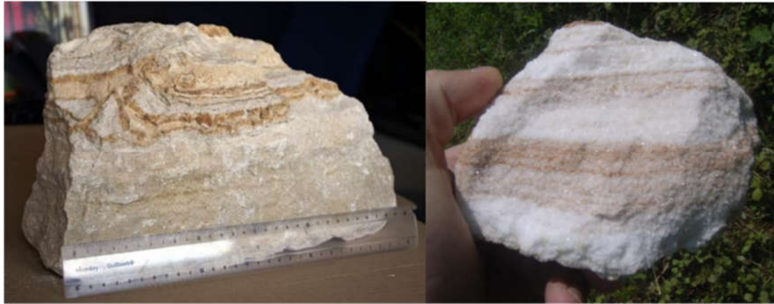
Figure II. 4 : A gauche, bloc de gypse saccharoïde pluri-décimétrique. A droite, Bloc de gypse saccharoïde décimétrique. (guide Méthodologique Analyse et Gestion des aléas ).
