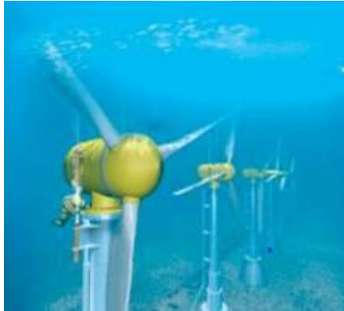
Figure I-2- Hydroliennes à écoulement libre (Mamadou DANSOKO 2014)
