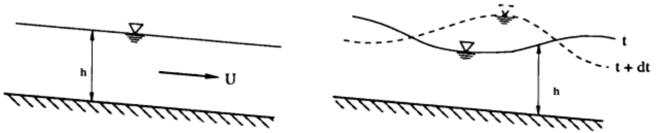
Figure II-7. Écoulement permanent et non-permanent
