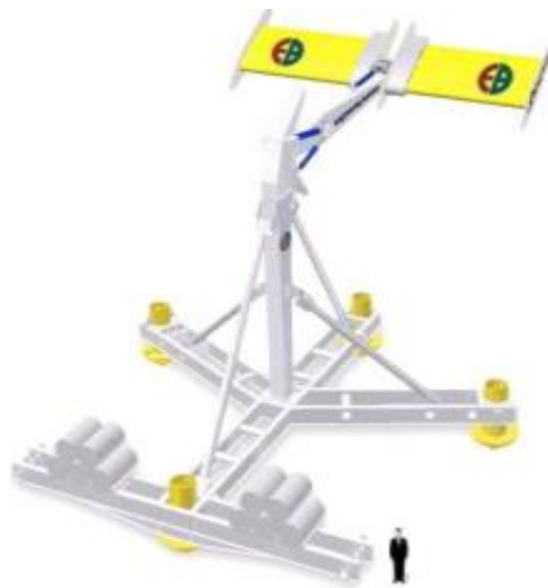
Figure –I .4. Hydrolienne à aile battante ou oscillante (Mamadou DANSOKO 2014)
