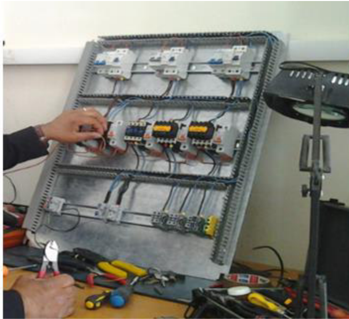
Fig.2-7 schéma pratique de câblage de l'armoire de commutation
