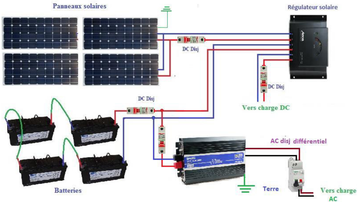
Fig.2-4 schéma de principe pour protéger la partie DC et AC de l'armoire
