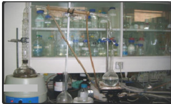
Figure 01: Montage d'hydrodistillation employé pour l'extraction de l'huile essentielle.
