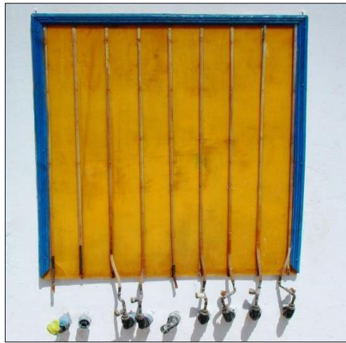
Figure II-09 Tableaux manométriques de mesure des niveaux d'eau
