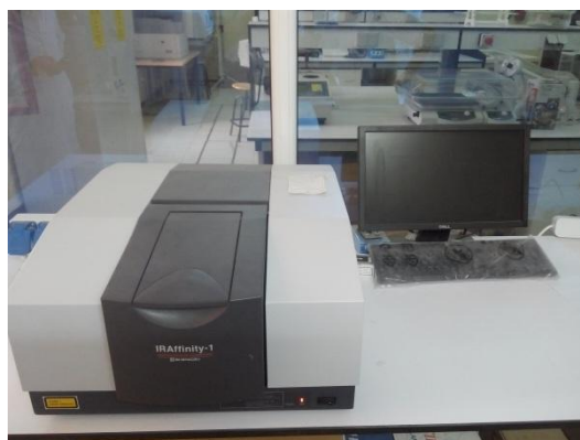
Figure 15: Spectrophotomètre infrarouge IRAffinity-1(Shimadzu) (VTRS, Univ. El Oued)
