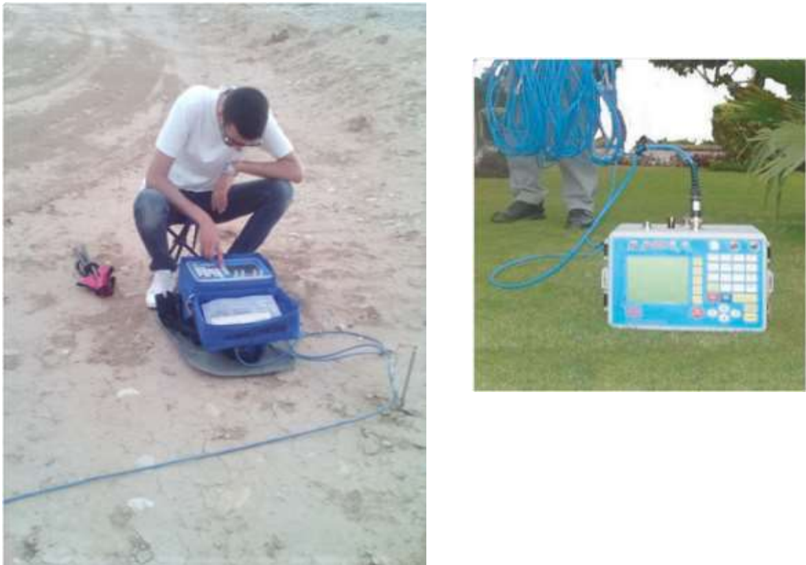
Figure IV.1 : Système d'acquisition SARIS de Scintrex et les câbles d'imagerie
