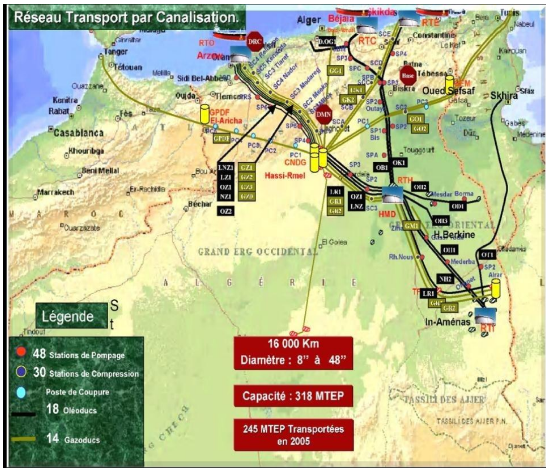
Figure II.1 : Réseau de transport par canalisation [18]
