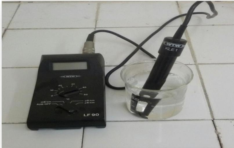
**Photo n<sup>0</sup>9 : Conductimètre**
