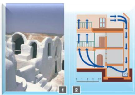
**Nous avons essayé d'utiliser les matériaux locaux qui ont une forte inertie thermique pour plus de confort à l'intérieur ( la pierre au RDC et la brique à l'étage avec une texture argileuse )**
