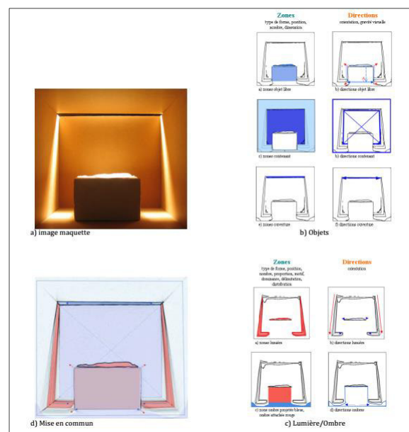
Figure 4: Représentation graphique d'une analyse des directions et zones d'un espace maquette. (Source : Biron et Demers, 2012)
