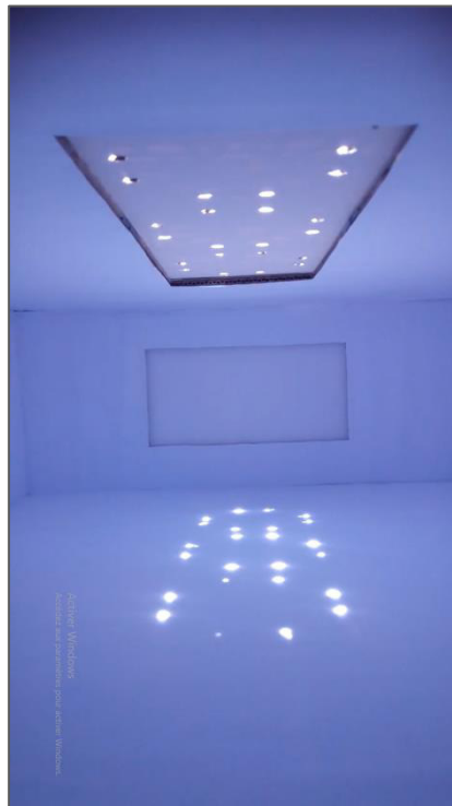
Figure 206: Le cas choisi: ouverture horizontale de huit ouvertures IRIS par module de moucharabieh avec un pourcentage d'ouverture IRIS de 25% (Source : auteur)
