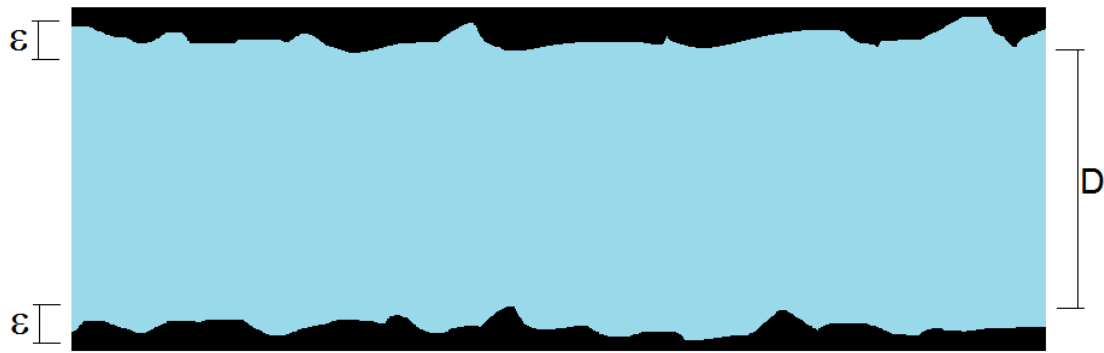
Figure III.1 La rugosité absolue et diamètre d'une conduite
