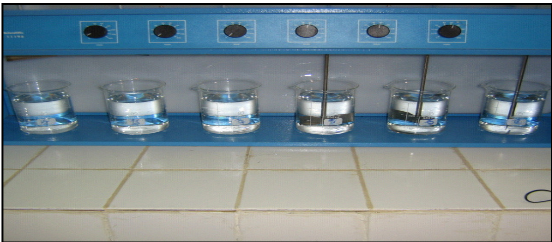
Figure 10: Floculateur de laboratoire utilisé pour les essais de coagulation-floculation
