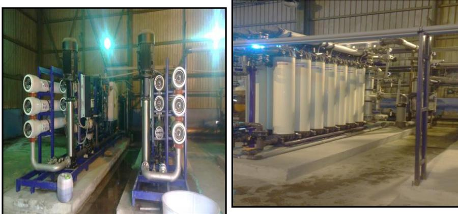
**Figure 16** : Installation de l'osmose inverse
