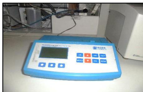
**Figure 27:** Spectrophotomètre multi paramètres HI 83200-02
