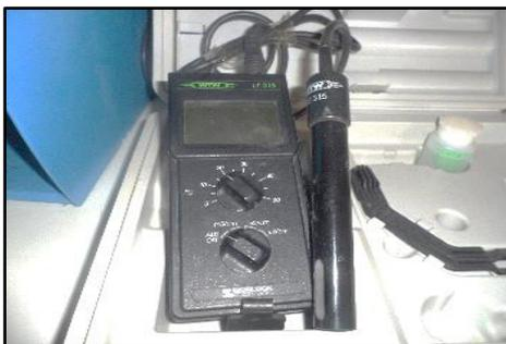
**Figure 21 :** Conductimètre utilisé au laboratoire
