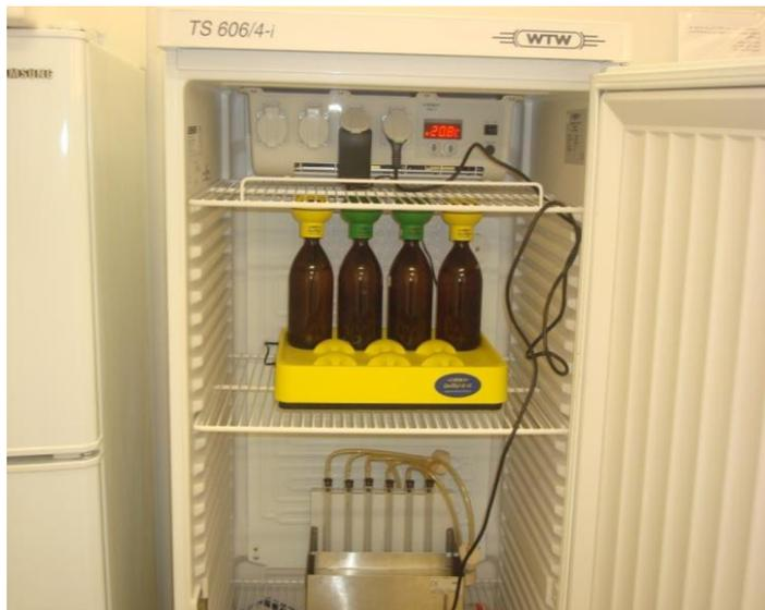
Figure 17: Appareils de mesure de la DBO5
