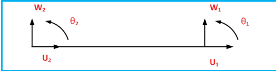
Figure (III.1) : Élément portique.
