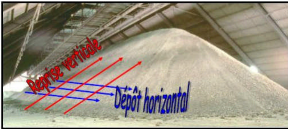
Figure I.7. Pré-homogénéisation du mélange calcaire-argile
