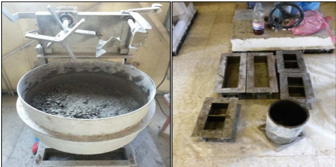
Photo III.7 .Malaxeur et moules utilisés pendant les essais
