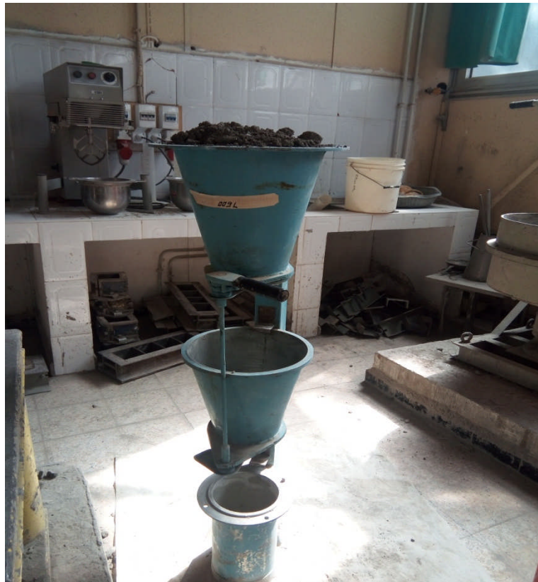
Photo III.15 .Dispositif de mesure de la compacité des bétons
