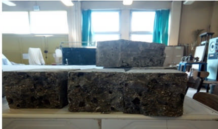
Photo III.12. Éprouvettes prismatiques ( 10*10*40) cm 3 après écrasement
