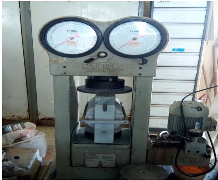
Photo III.13. machine et dispositif d'essai de traction par fendage
