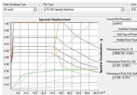
(Figure 4.16) : Courbe point de performance à une structure d'étage souple.
