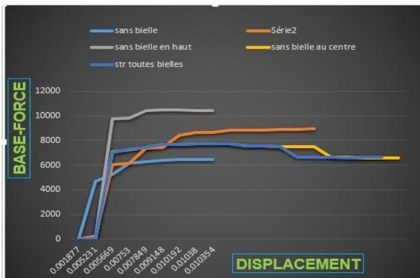
(Figure 4.25) : Courbe de capacité (effort tranchant-déplacement)
