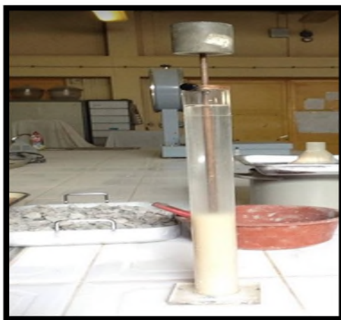
Photo III.9 : équivalent de sable mesuré au piston.
