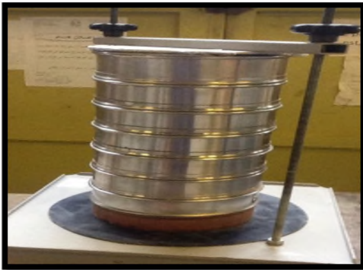
Photo III.5 : Tamis et tamiseuse électrique.
