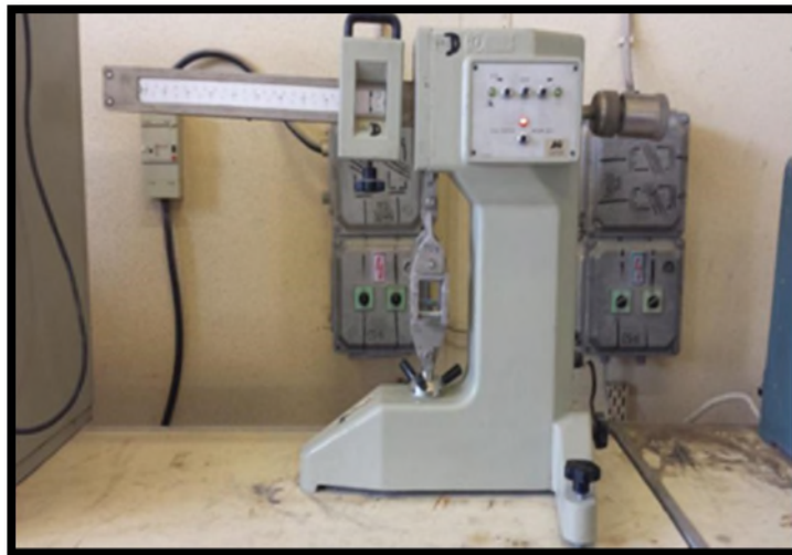
Photo III.22 : Presse hydraulique pour l'essai de traction par flexion.
