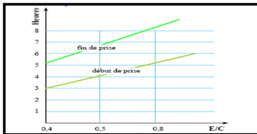
Figure I.7 : influence de l'E/C (eau/ciment) sur le temps de prise. [12]
