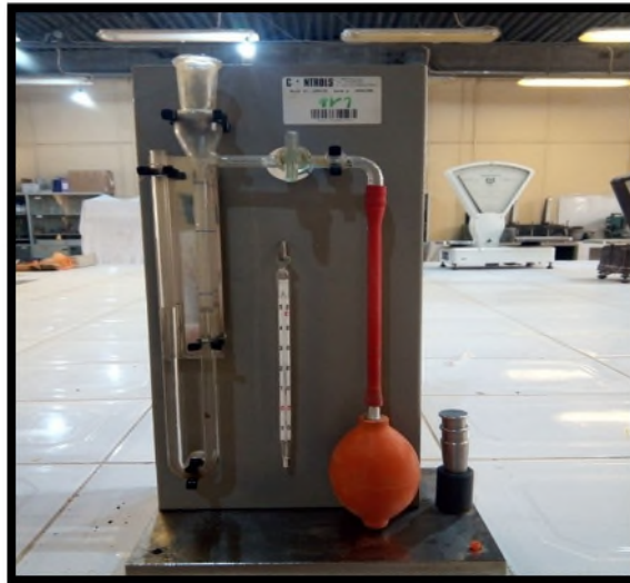
Photo III.1 : Dispositif employé pour la mesure de la finesse (Perméabilimètre de Blaine).
