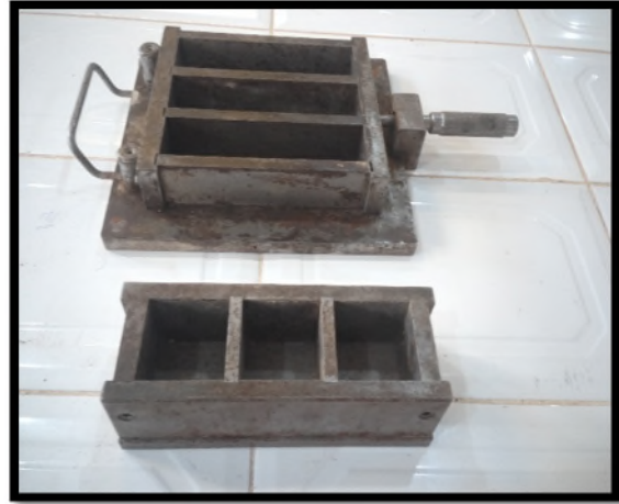
Photo III.18 : Les moules métalliques.
