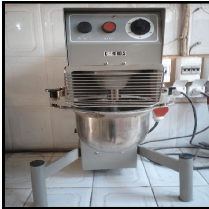
Photo III.16 : Malaxeur d'une capacité maximale de 5 L.
