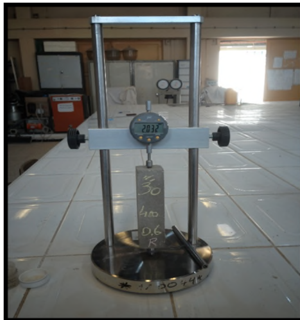
Photo III.23 : Dilatomètre à comparateur pour retrait- gonflement du mortier.
