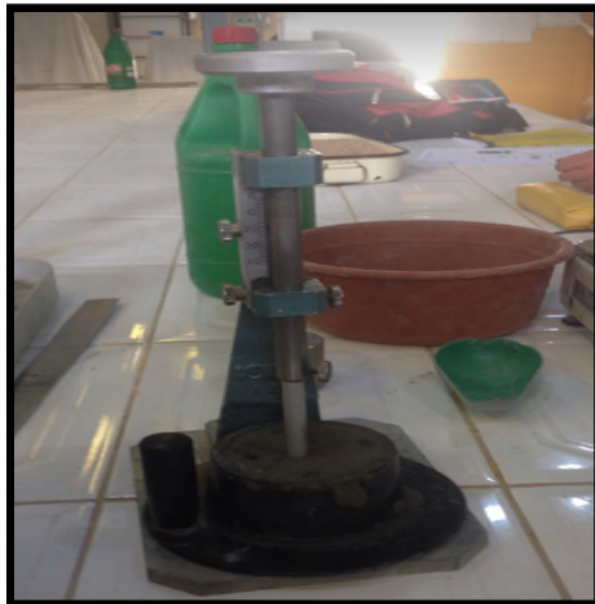
Photo III.3 : Dispositif employé pour les mesures de la consistance et les temps de prise (Appareil Vicat)
