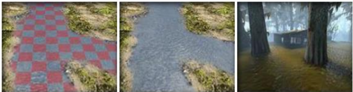
Figure 1.5: Rendu en temps réel de rivières à l'aide de pavés de textures [12]. Gauche: la surface de la rivière est subdivisée en "tuiles". Chaque tuile a sa propre direction et vitesse de vague, qui sont interpolées en douceur pour produire l'animation de la surface de la rivière. Au milieu: rivière avec ondes directionnelles. Droite: surface animée du marais
