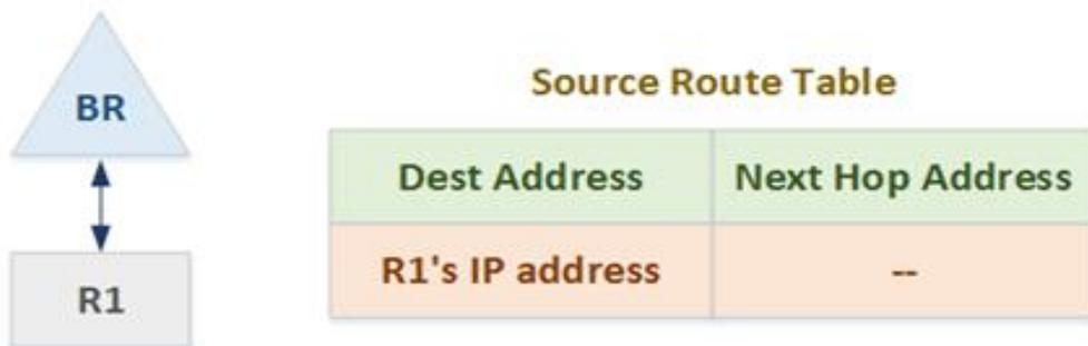
Figure 2.8 : la 1ere étape pour construire la table de routage source[17].
