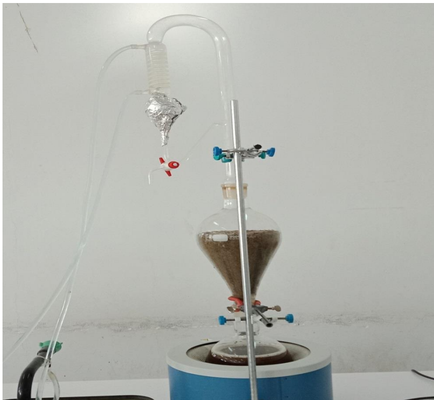
Photos 18: l'appareil de type Clevenger utilisé pour l'extraction (Photo originale).
