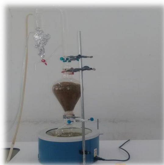
**Figure 4.** Montage de type Clevenger
