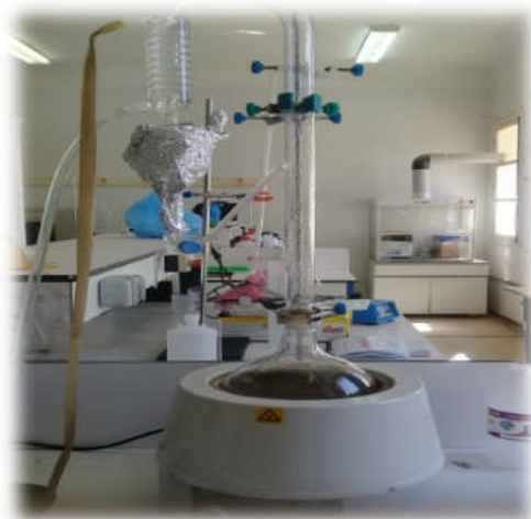
Photo 3. L'extraction des huiles essentielles par hydrodistillation dans un appareil de type Clevenger
