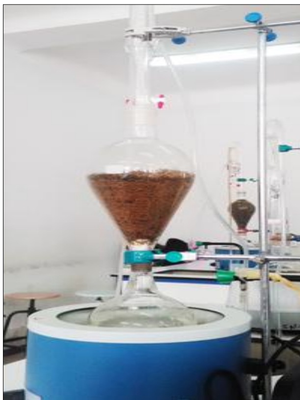
Figure 5. Montage d'extraction par entraînement à la vapeur d'eau (Photo originale).
