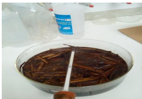
Figure 16: DPLF immergée dans la solution de NaOH 1% après 24 h (Source : Auteur)
