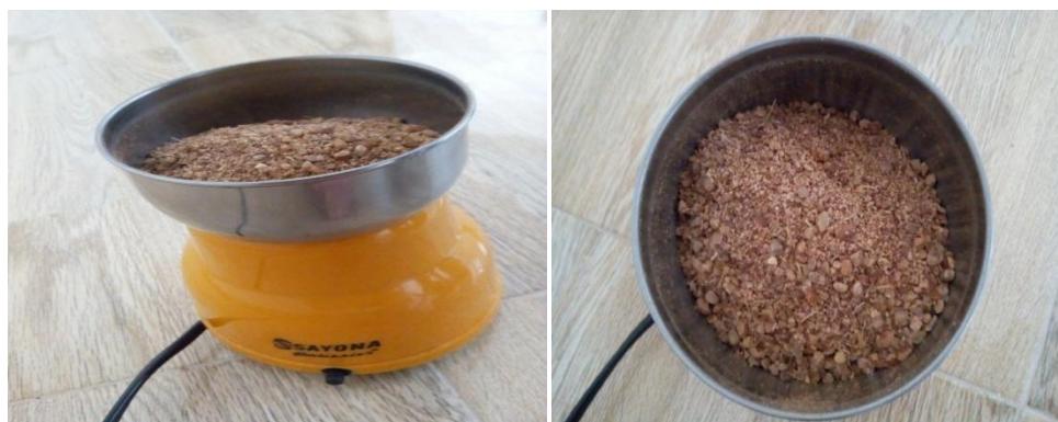
Figure 10: Les noyaux de datte broyés par un moulin à café domestique. (Source : Auteur)
