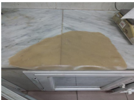
Figure 22: Une bande de PVC vierge obtenue par calandrage (Source : Auteur)
