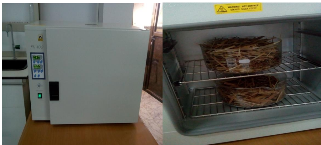
Figure 12: DPLF séché dans l'étuve à 80°C pendant 2h (Source : Auteur)
