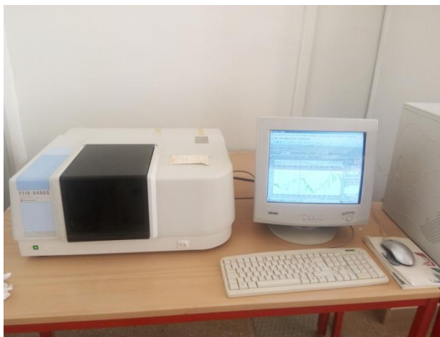
Figure 26: Spectrophotomètre à transformée de Fourier de type SHIMADZU FTIR-8400S (Source : Auteur)
