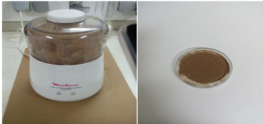
Figure 17: Broyage et tamisage de DPLF traité par NaOH (Source : Auteur)
