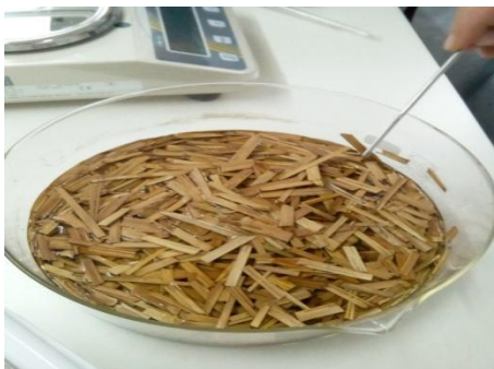
Figure 15: DPLF immergée dans la solution de NaOH 1% (Source : Auteur)
