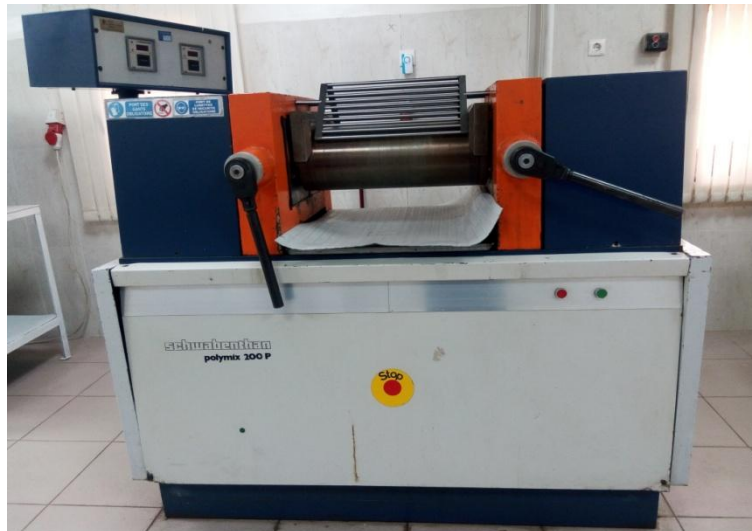
Figure 23: Machine de calandrage Schwabenthan polymix 200 (Source : Auteur)
