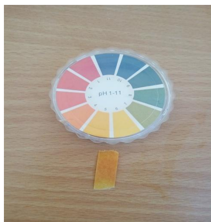
Figure 19: PH acide après neutralisation par acide acétique (Source : Auteur)
