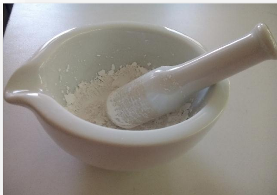
Figure III.3 : Mélange et broyage des échantillons dans un mortier.
