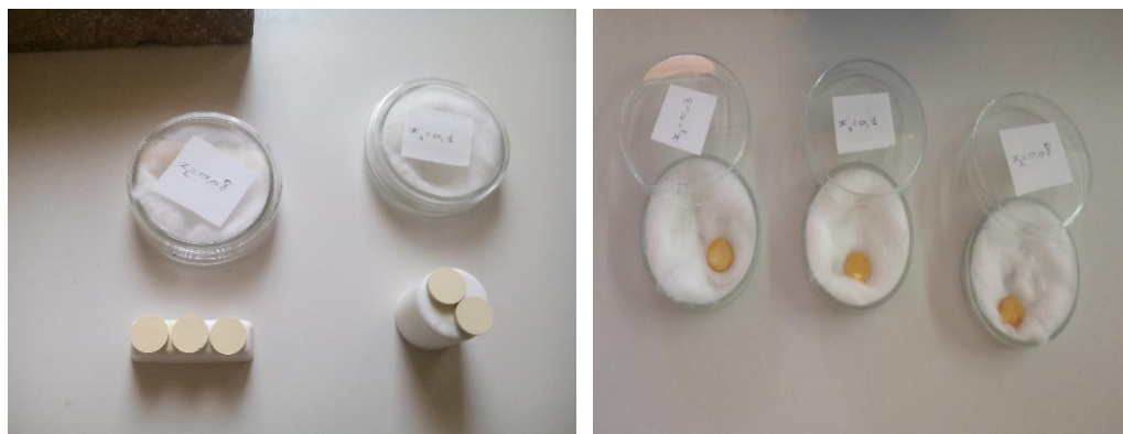
Figure III.7 : Les échantillons avant et après le frittage.
