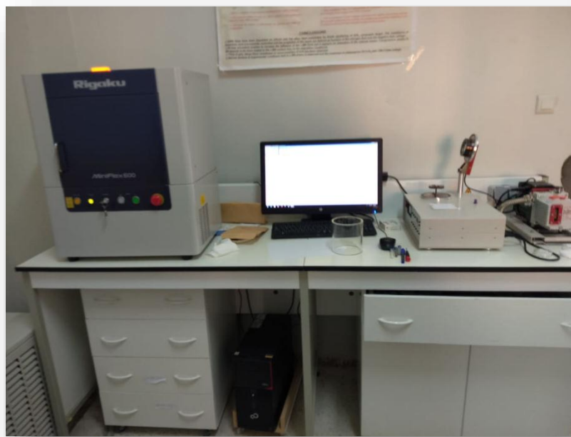
Figure II.8 : Diffractomètre de type Miniflex600.
