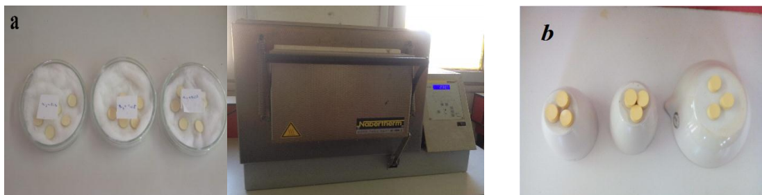
(a) les pastilles avant calcination et le four programmable, (b) les pastilles après calcination
