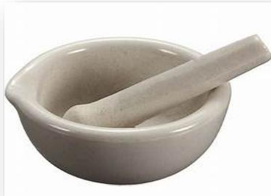
Figure II.2 : Mortier utilisé pour le broyage.
