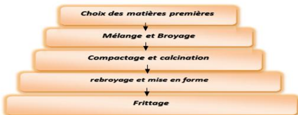
Figure II.1 : Organigramme de l'élaboration d'une céramique.
