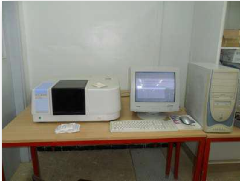
Figure II.9 : Spectromètre Infrarouge à transformée de Fourier FTIR-Shimadzu 8400S.
