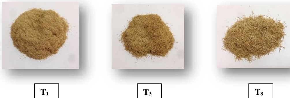
Figure II.4 : Les fibres obtenues après le tamisage
