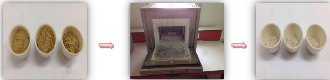
Figure III.2 : incinération d'une prise d'essai.
