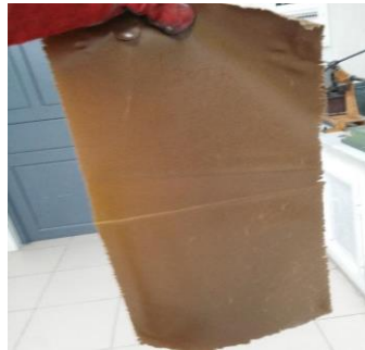
Figure II.8 : le film du composite obtenu par la calandre.
