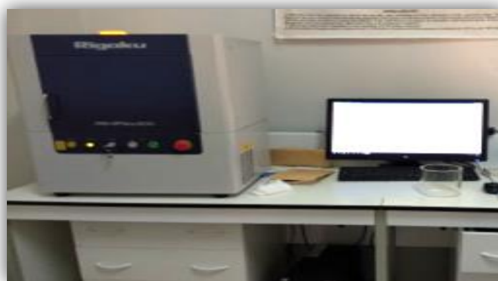
Figure II.10 : Le diffractomètre des rayons X MiniFlex600 RigaKu".
