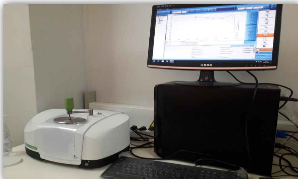
Figure II.11: Spectromètre infrarouge IR de type PerKinElmer UATR Two.
