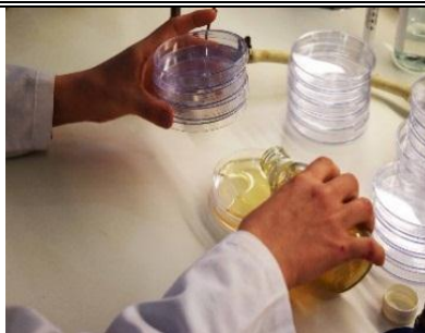
Figure(31) : coulage des boites
