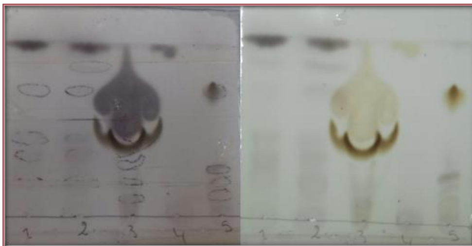
Figure IV.2 : Photographie des chromatogrammes des HE rameaux et cônes et les huiles commerciales de Camphre, Cèdre, et Rosemary. (Ether de pétrole /dichlorométhane)
