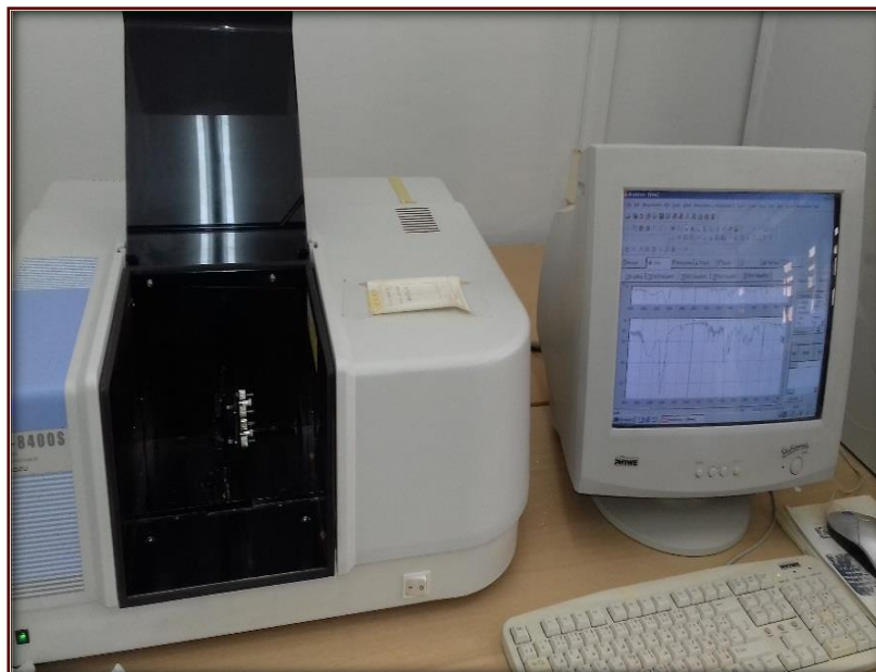
Figure III.4 : Le spectromètre infrarouge (FTIR) de type (FTIR-8400 S).
