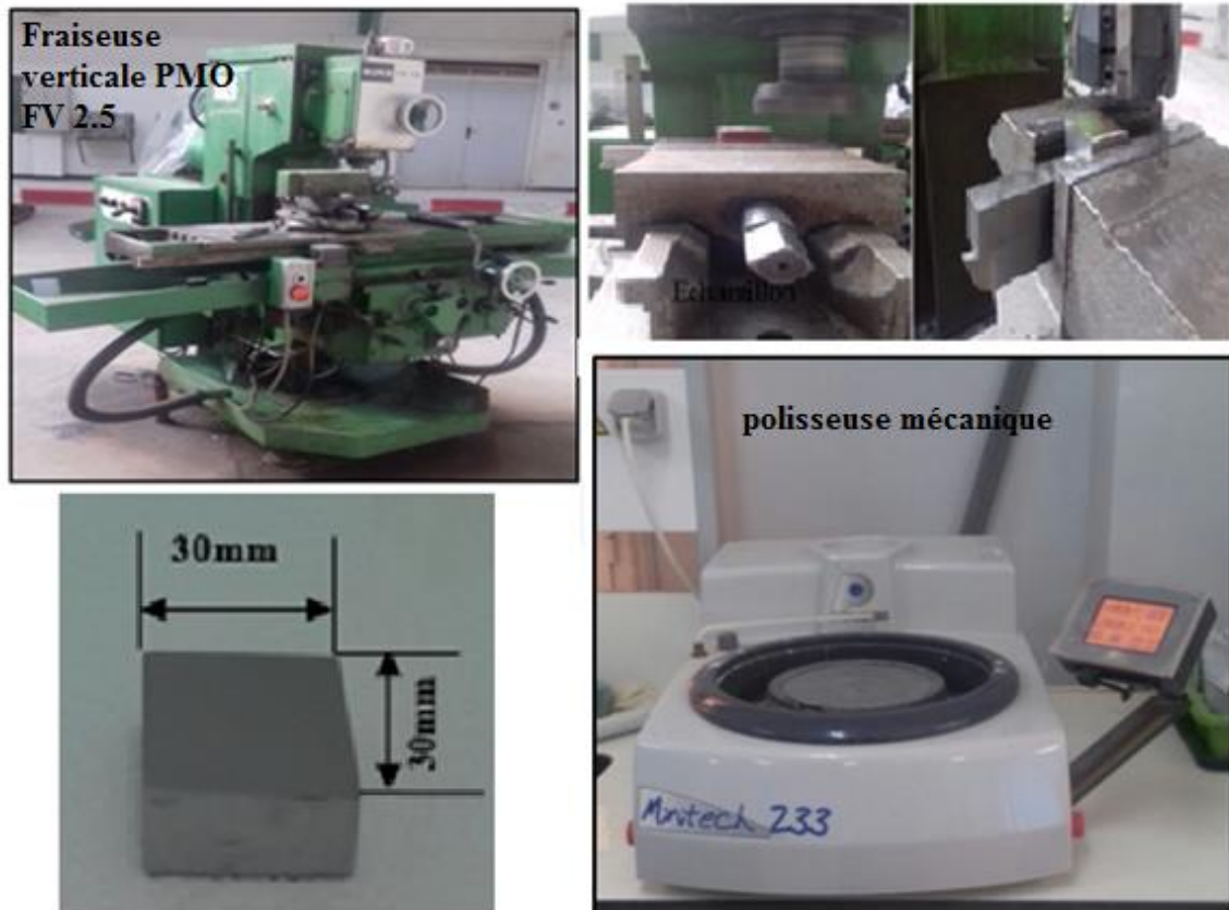
Figure III. 6 : Les étapes de préparation des échantillons de travail.
