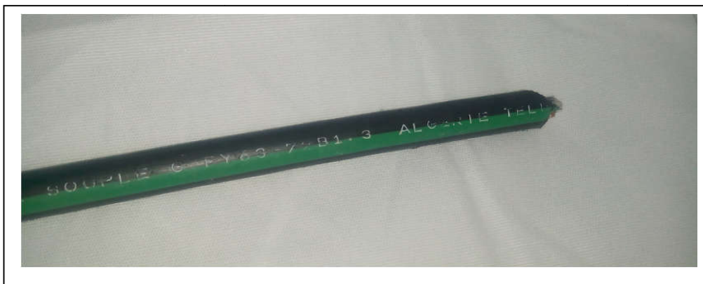
Figure IV.1 : câble réel de fibre optique monomode
