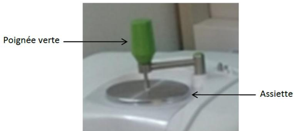
Figure II.9 : Mise en place de l'échantillon.
